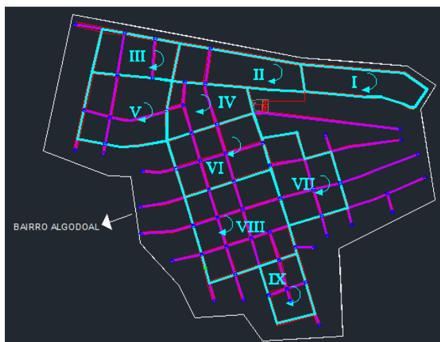
Figura 4. Rede malhada de distribuição de água para o bairro de algodual – Abaetetuba.
