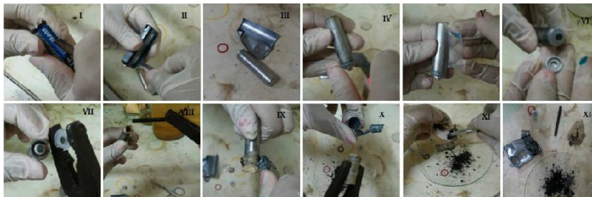
Figura 1.1. Procedimento para abertura de pilhas do tipo Leclanché (Zn/MnO 2 )
