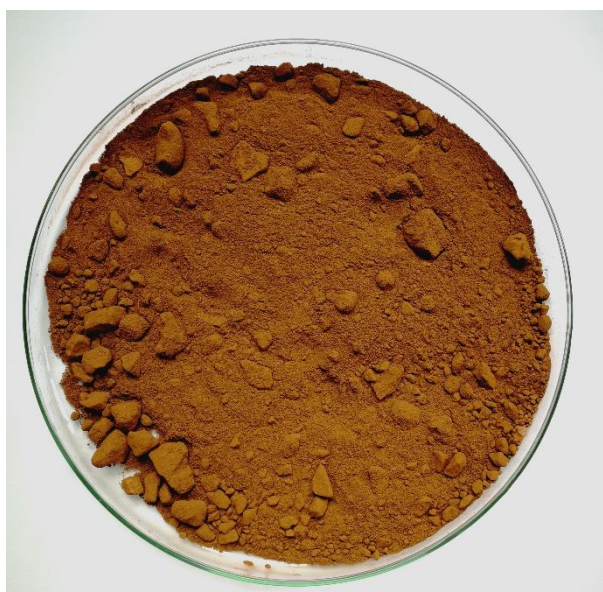
Figura 1. Amostra de minério após processo de secagem em estufa a 105°C durante 24 h.
